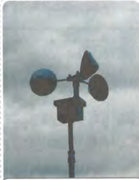
الأنيمومتر لقياس سرعة الرياح.
